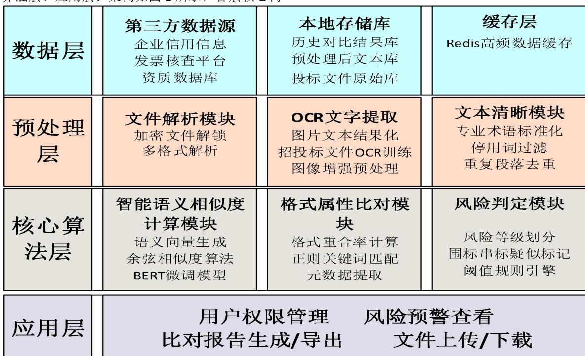
图 1：投标文件相似度比对软件系统架构图
