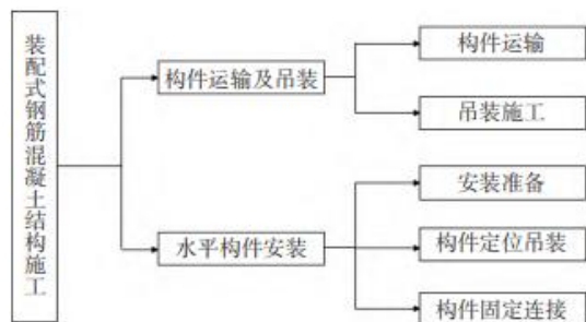
图 2：装配式房屋建筑工程的混凝土结构基本施工流程
