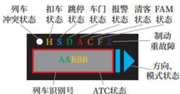
图 3：轨道交通信号系统的ATS车组号显示界面
