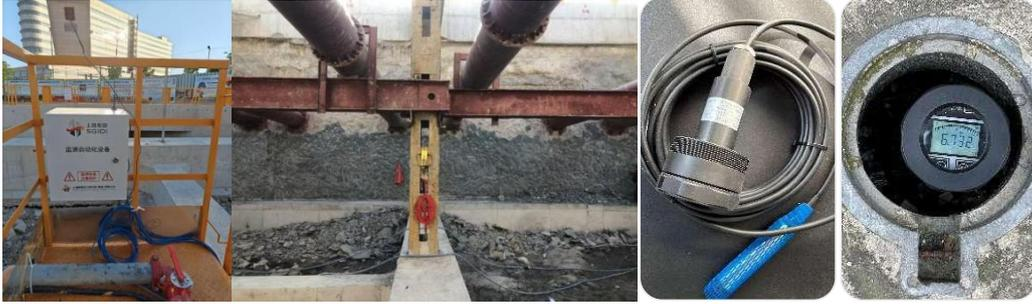
轴力自动化采集 (1 自动化采集箱 2 四通道自动化采集盒 3、4 自动化水位计)
